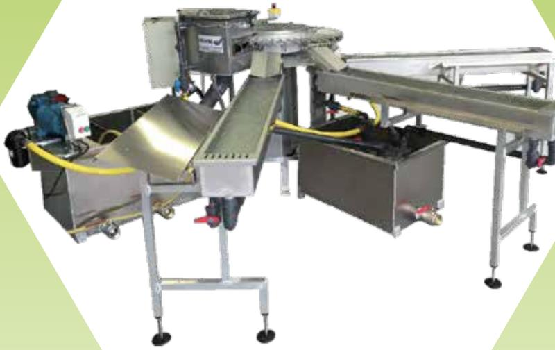
*Contenedor de agua para calibradora circular*
